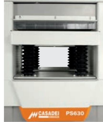
Powered 2 speeds thickening table raise & fall, with micrometric adjustment of the working height and 4 steel screws protected by dust. Noise reduction lips positioned at front and rear of machine table. Motorisierte Höhenverstellung des Dickentisches mit 2 Geschwindigkeiten, mit mikrometrischer Einstellung und durch 4 Stahlschrauben, die durch Staubschutzbälge geschützt sind. Lärmschutzklappen am Einlauf und am Auslauf.
