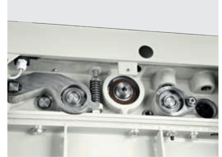
Feed rollers mounted on independent floating ball-bearing bushes. Auf separat beweglichen Pleuelstangen und Kugellagern schwingende Vorschubwalzen.
